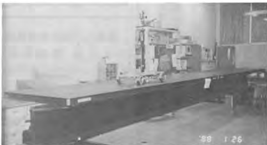
熱機関第1実験室 小林, 市川先生 自動車の走行性能実験装置 自動車の惰行、加減速性能などの実験に用いる装置
