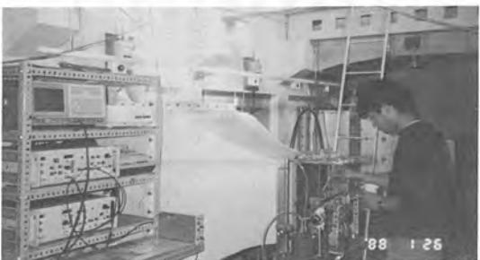
熱機関実験室2 田中, 鈴木(六)先生 風洞試験部に設置した平板翼の性質を調べる。
