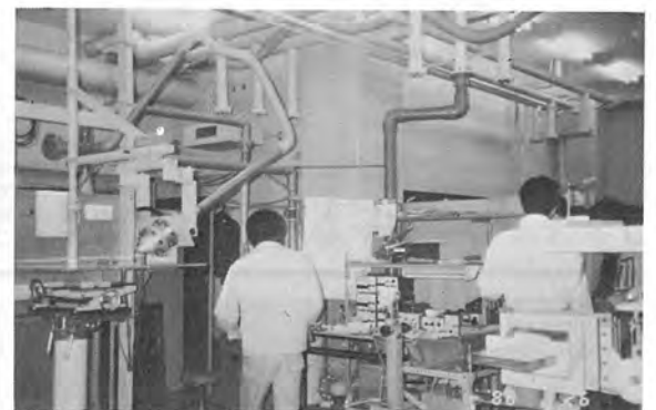
流体工学実験室 浅沼, 飯島, 弓野, 円能寺先生 衝突空気噴流の実験 円形(軸対称)ノズルから空気を噴出し平板に衝突させ、そのときの速度や乱れ分布を測定している。 右下には同様の実験を矩形(二次元)ノズルによって行う装置がみえる。
