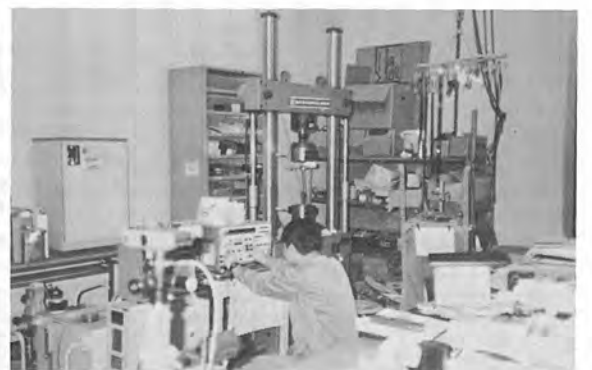
材料加工実験室 福迫, 栗山, 林先生 コンピュータ制御疲労試験機(10トン)、自作した熱交換器、輸送機械用部材のひずみ制御疲労強度および腐食疲労き裂伝播測定など材料強度に関する実験を行っている。
