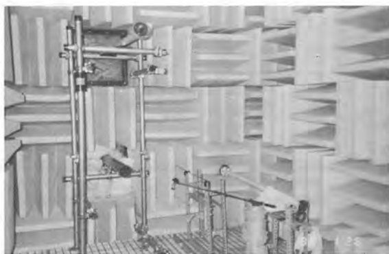
熱工学実験室 萩, 村上, 前田先生 くさびの長さが60cmの無響室で、マフラーの性能試験などに用いられる各種の管路系装置の先端部が挿入されている。
